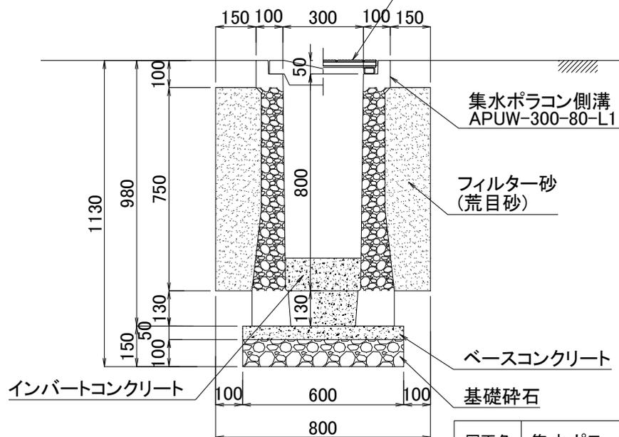
図面名 集水ポラコン側溝施工断面図
