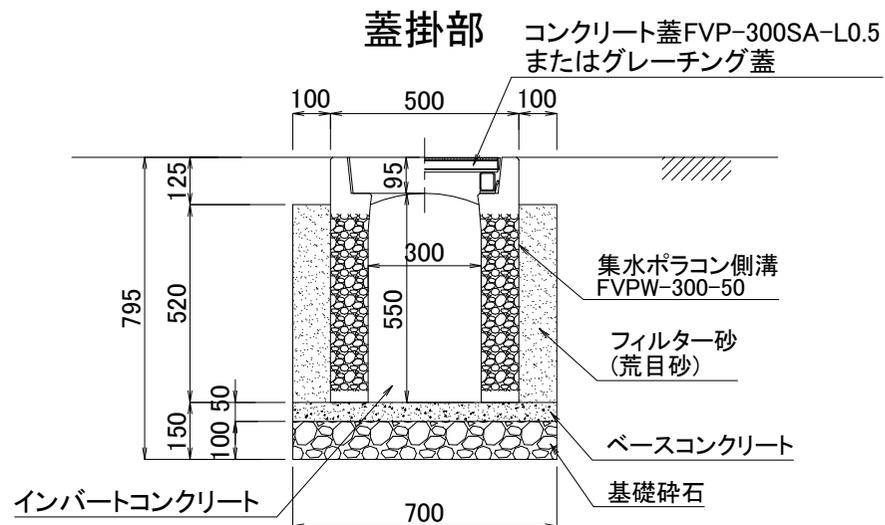
図面名 集水ポラコン側溝施工断面図
